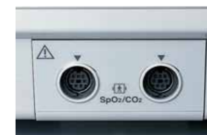
Unité d'interface DSI QI-552V pour SpO 2 et CO 2 Unité d'interface de sortie DSI/ AUX QI-553V (non illustrée) pour SpO 2 /CO 2 /AUX
